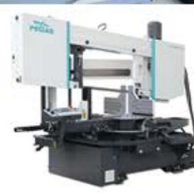
Полуавтоматические двухколонные станки
