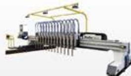
**Master** – высокоточная машина для резки с ЧПУ
