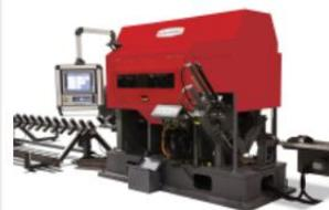
ЛИНИЯ ПРОБИВКИ УГОЛКА
